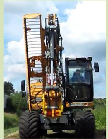
Durch die Schwenkeinrichtung lässt sich, bei Bedarf, auch in geneigter Position arbeiten. Eine zusätzlicher Schwenkwinkel zur anderen Seite (+ 15 °) kann auf Wunsch ggf. angeboten werden. Individuelle Sonderlösungen, angepasst an die bestehenden Voraussetzungen am vorhandenen Bagger, sind auf Anfrage möglich.
