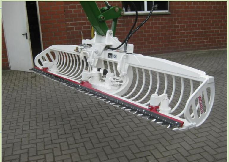
Bei Einsatz der hydraulischen Schwenkeinrichtung ist ein zusätzlicher Ölförderkreis erforderlich.
