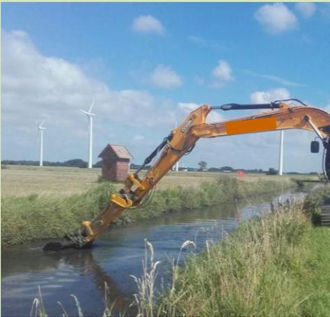
Mit der abnehmbaren Stielverlängerung wird bedarfsweise schnell eine größere Reichweite erzielt. Die Verlängerungen werden individuell geplant und sind in verschiedenen Ausführungen erhältlich.
