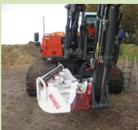
Der bewährte Hochleistungs-Getriebeantrieb von MICHAELIS und eine leichter dimensionierte Konstruktion bilden (wahlweise auch im Zusammenhang mit einer Schwenkeinrichtung) den idealen Mähkorbtyp für flexible Anwendungen zur zeitgemäßen Unterhaltung von Wasserläufen.
