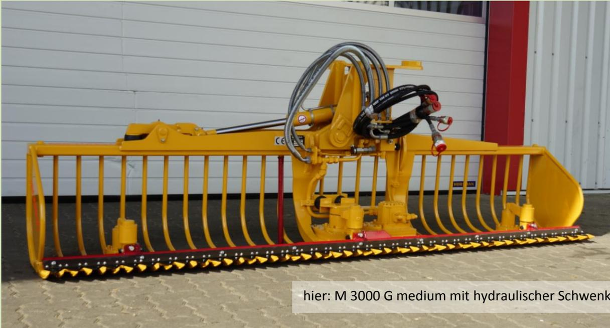
hier: M 3000 G medium mit hydraulischer Schwenkeinrichtung
