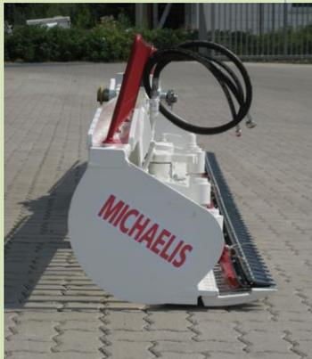
Medium in extra niedriger Bauform für enge Grabensohlen, Korzhöhe 100 mm niedriger. Durch das reduzierte Gewicht auch für Auslegerbetrieb geeignet.
